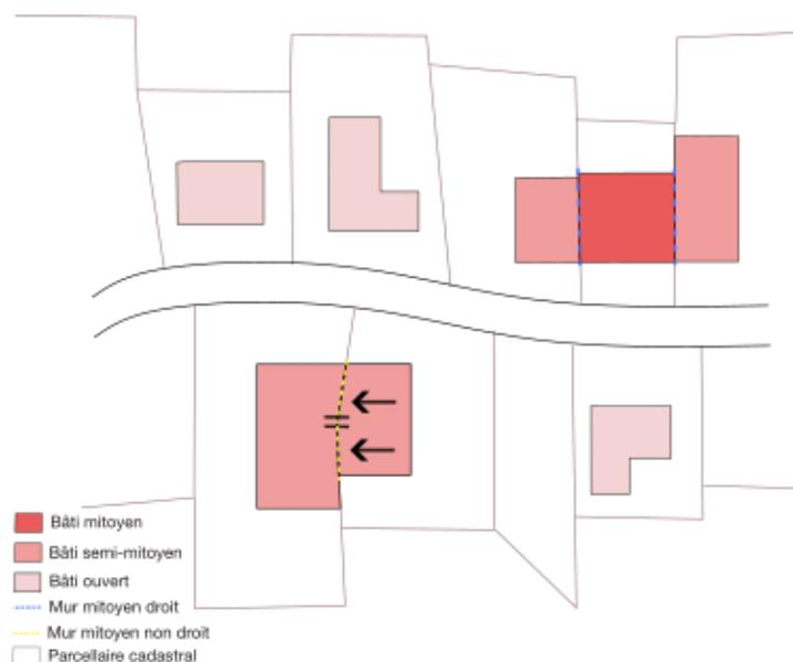
Figure 4. Schéma illustrant l'erreur liée à la subdivision des murs mitoyens en plusieurs segments. Le bâtiment semi-mitoyen au bas à gauche du schéma sera considéré par erreur comme mitoyen en raison de la présence d'un mur mitoyen non droit
