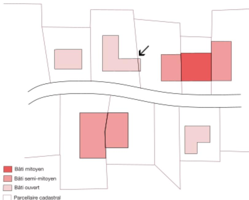
Figure 5. Schéma illustrant l'erreur liée au découpage d'un bâtiment par le parcellaire cadastral. Le bâtiment ouvert sera considéré par erreur comme deux bâtiments semi-mitoyen en raison du débordement sur la parcelle adjacente.
