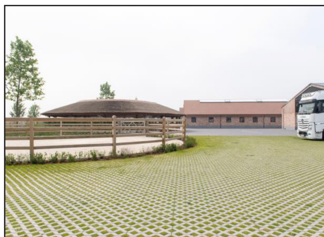
Figure 7 : Parking pour engins lourds réalisé en dalles gazo
