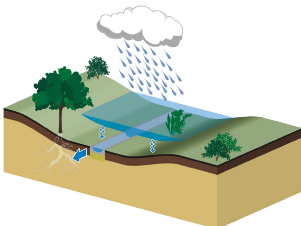
Figure 3: Noue infiltrante à cunette en son creux pour écouler les petits épisodes pluvieux et le début et/ou la fin des épisodes plus rares afin d'éviter les flaques. Source: Architecture et Climat
