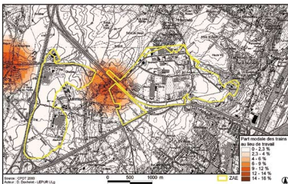
Figure 4 : Part modale attendue pour les trains au lieu de travail dans le parc d'activités des Hauts-Sarts (Herstal) SOURCES : SNCB, 2003 ET INS, 1991.
