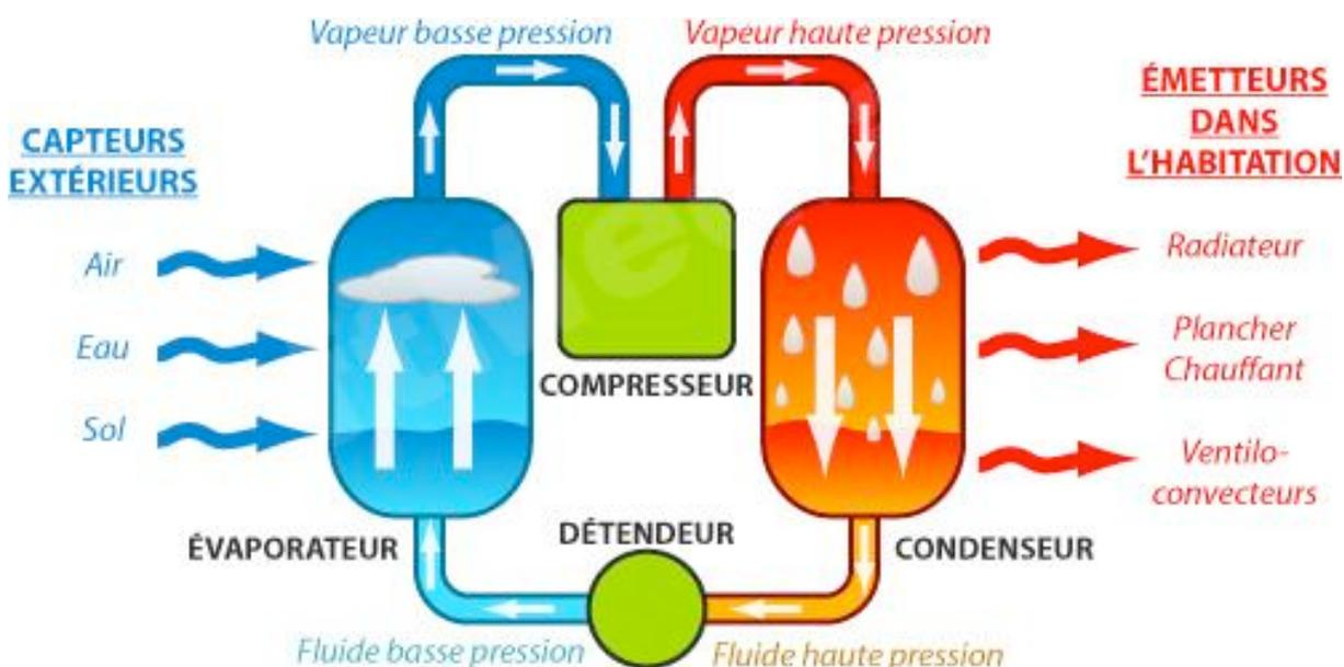
**Figure : Schéma de principe de la pompe à chaleur**
